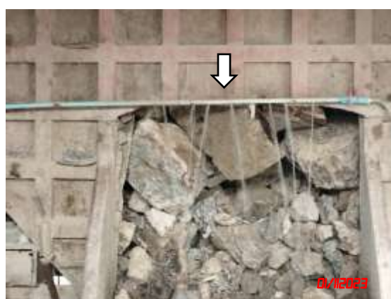
ระบบสเปรย์น้ำบริเวณจุดกำเนิดฝุ่นละออง
